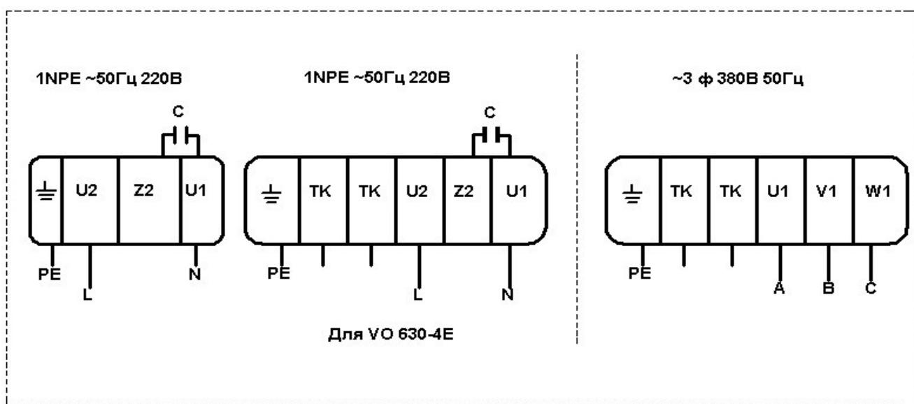
е) проверить соответствие напряжений питающей сети и двигателя; При подключении двигателя требуется обратить внимание на наличие защитных термоконтактов. При наличии защитного термоконтакта необходимо подключить его к соответствующему входу щита управления к которому подключается вентилятор. В случае отсутствия защитного термоконтакта для защиты двигателя рекомендуется применять электротепловое реле с точной подстройкой порога срабатывания защиты.
