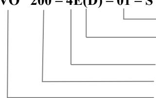
Направление воздуха: S- от двигателя; В - на двигатель
